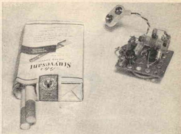
Il radiomicrofono montato. Per un'idea delle dimensioni, si veda il paragone con le sigarette.
